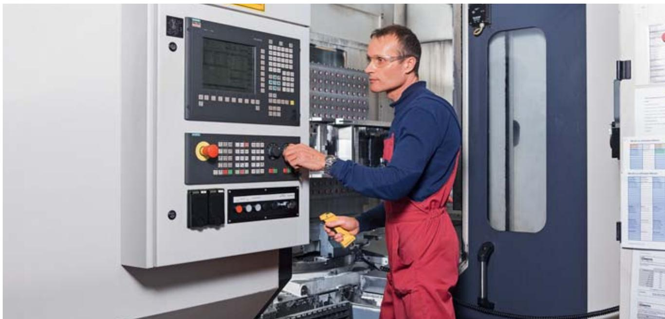
Hansjörg Boss kann heute dank einem Zustimmtaster an der offenen Maschine arbeiten, ohne dass er die Schutzeinrichtung an der Tür ausser Kraft setzen muss.
