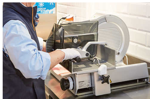
Image 2: utilisation correcte de la trancheuse
