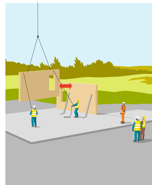
Regel 8 Auf Gefahr durch schwebende Last achten.
