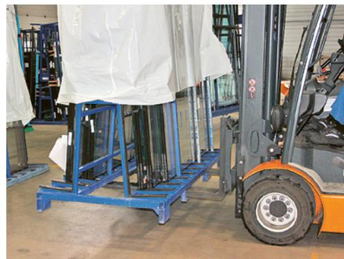
8 Châssis avec encoches pour les fourches de chariots élévateurs
