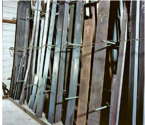
2 Vertikal gelagerter Formstahl in Gestellen, die gegen Rutschen und Umstürzen gesichert sind
