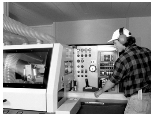
6 Alimentation mécanisée (MEC): dans le cas d'une alimentation mécanisée, la pièce ou l'élément de machine comprenant l'outil est guidé mécaniquement, et la pièce est maintenue (par ex. raboteuse quatre faces, tenonneuse double, centre d'usinage CNC).
