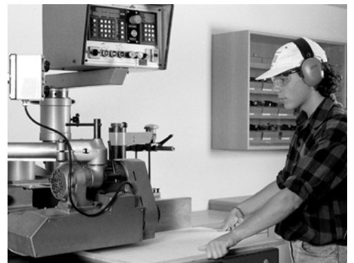
4 les travaux avec une unité d'alimentation mécanisée.
