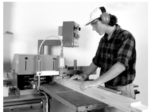
5 les travaux avec un chariot coulissant.
