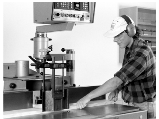
3 Alimentation manuelle (MAN): on entend par alimentation manuelle le maintien et le guidage manuel de la pièce.
