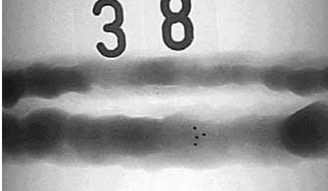
Radiogramme d'une soudure défectueuse
