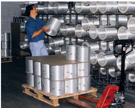
Die 25 kg schweren Glasfaserspulen wurden früher von Hand für die Weiterverarbeitung aufgereiht.
