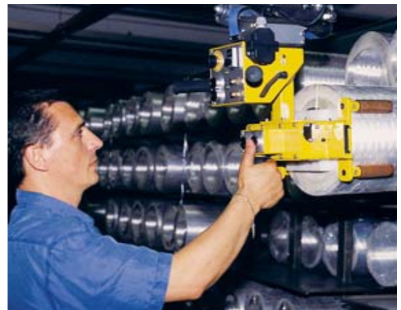
Heute wird die gleiche Arbeit mit einem Hebegerät (Gewichtsbalancer) ausgeführt. Durch die Mechanisierung ist die Arbeit wesentlich sicherer, gesundheitsverträglicher und wirtschaftlicher geworden.
