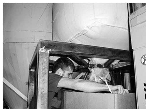
Fig. 5: ouverture sans danger des big bags grâce à une station de vidage équipée d'un support mécanique.
