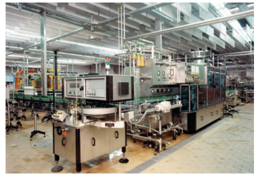
5 Baffle costituiti da pannelli di lana minerale in una ditta produttrice di bevande (impianto di imbottigliamento)
