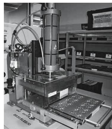
Foto 9: dispositivo di alimentazione (avvio della corsa al raggiungimento della posizione posteriore del banco, massimo 6 mm).
