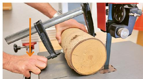
6 Pièce ronde de grand diamètre. L'opérateur stabilise la pièce avec un serre-joint et cale le bras de serrage sur le bord de la table pour créer un deuxième point d'appui.
