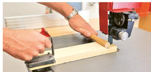
5 Pièce ronde de faible diamètre. L'opérateur utilise un bois auxiliaire permettant d'éviter que la pièce tourne.
