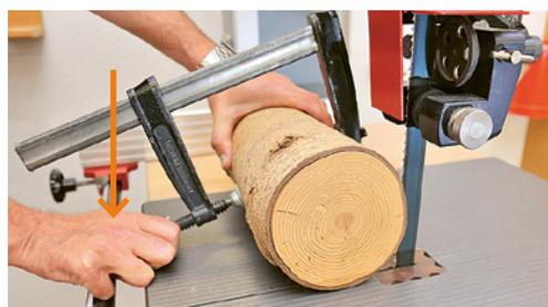
7 Pièce ronde de grand diamètre. L'opérateur stabilise la pièce avec un serre-joint et cale le bras de serrage sur le bord de la table pour créer un deuxième point d'appui.
