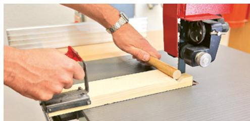
6 Pièce ronde de faible diamètre. L'opérateur utilise un bois auxiliaire permettant d'éviter que la pièce tourne.
