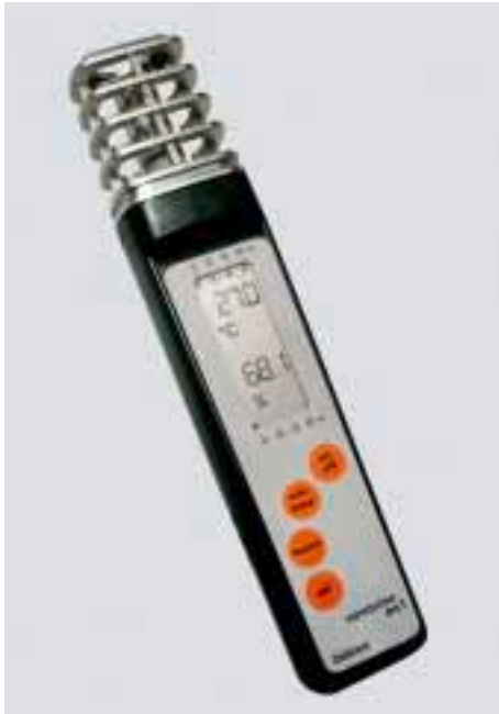
Figura 3 Apparecchio semplice per misurare la temperatura secca e l'umidità dell'aria.
