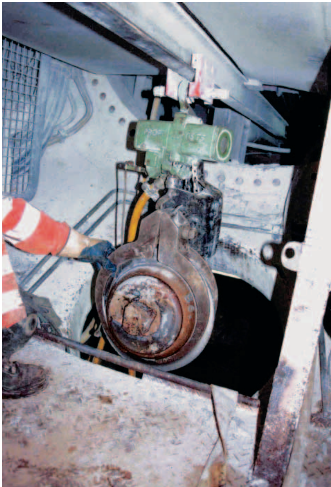
Figura 6 Sostituzione di punte su una testa di scavo: un'attività particolarmente esposta al calore umido.
