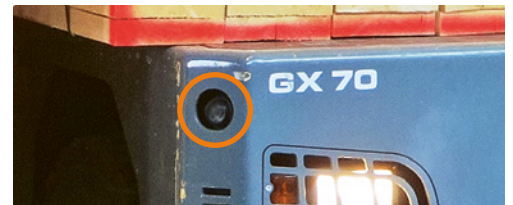
6 Kamera vorne rechts eingebaut
