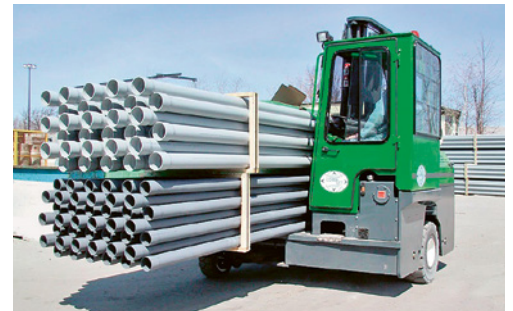
5 Die Rohre sind mit Holzrahmen und Stahlbändern gesichert. So können sie mit dem Vierwegstapler sicher transportiert und eingelagert werden.
