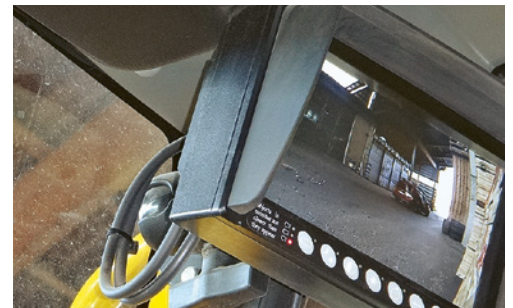
8 Monitor mit Bild der Kamera vorne rechts bei eingelegtem Vorwärtsgang
