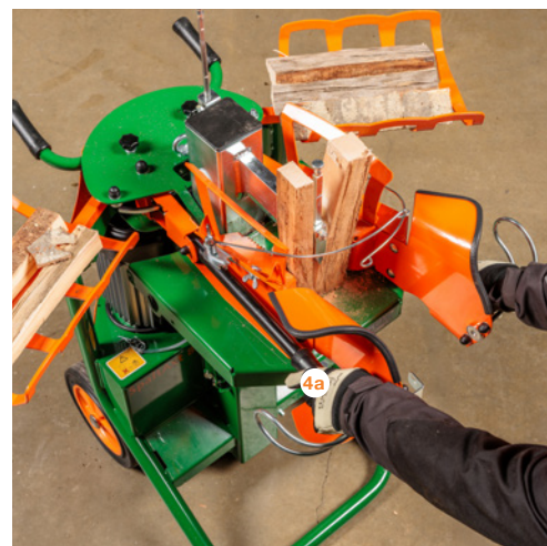
4 Fendeuse verticale pour petites bûches avec commande bimanuelle (4a).
