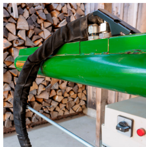
5 Tuyaux hydrauliques gainés offrant une protection contre les blessures pouvant résulter d'une fuite de fluide hydraulique.
