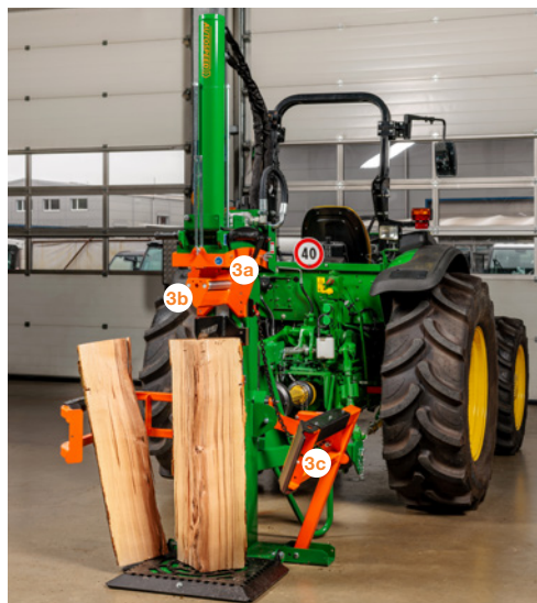
3 Fendeuse de bûches pour bois enstéré avec commande bimanuelle (3a) et dispositif d'arrêt automatique (3b). Le coin à fendre s'arrête automatiquement dès qu'une bûche coincée actionne le dispositif d'arrêt automatique. Le protecteur (3c) préserve l'utilisateur de la chute ou du rejet des morceaux de bois.
