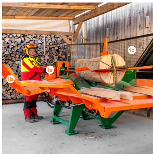
1 Fendeuse de bûches avec commande bimanuelle (1a) et dispositif d'alimentation (1b) pour bois enstéré. Le protecteur (1c) empêche d'introduire les mains dans la zone de fendage.
