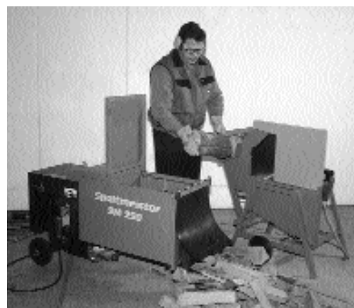
Figure 2: fendeuse horizontale pour petites bûches, avec dispositif de fente recouvert et verrouillé
