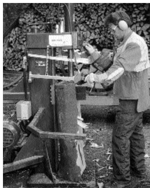
Figure 3: fendeuse verticale pour bois enstéré, avec une commande bimanuelle et un dispositif racleur. Le coin à fendre s'arrête automatiquement si une bûche coincée bloque le dispositif racleur. Le protecteur préserve l'utilisateur de la chute ou du rejet des morceaux de bois.
