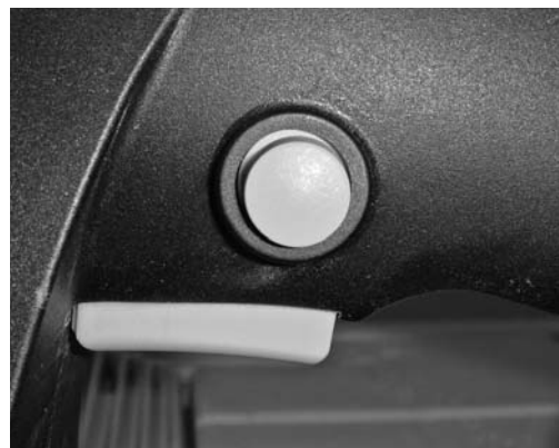
Fig. 3: une sécurité empêche une mise en marche involontaire.
