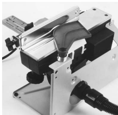
Fig. 2: raboteuse portable en position fixe équipée d'un protecteur et d'un support.
