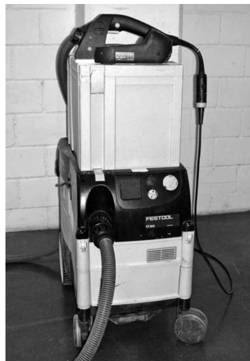
Fig. 4: raboteuse portative raccordée à un dispositif d'aspiration.
