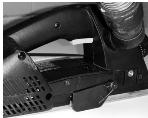
Fig. 1: protecteur mobile latéral recouvrant l'arbre.
