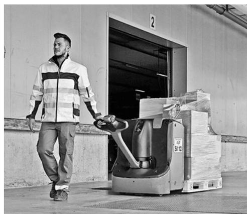
4 Les chariots à timon long sont faciles à manier et sans danger pour l'opérateur: les talons sont tenus éloignés du châssis.
