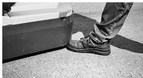
3 Un faible écart châssis-sol (35 mm max.) et le port de chaussures de sécurité assurent la meilleure protection des pieds.
