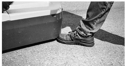
**3** Un faible écart châssis-sol (35 mm max.) et le port de chaussures de sécurité assurent la meilleure protection des pieds.
