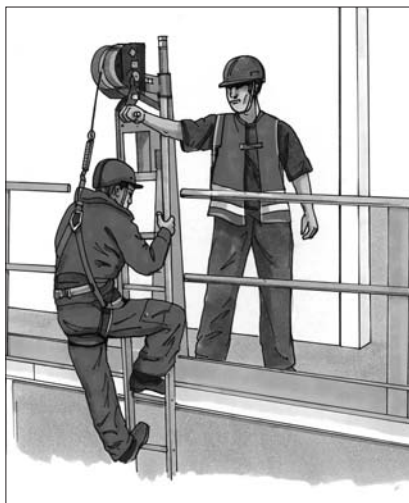
12 Descente dans le silo au moyen d'une échelle associée à un antichute à rappel automatique équipé d'un dispositif de sauvetage
