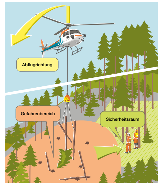
4 Gefahrenbereich und Sicherheitsraum
