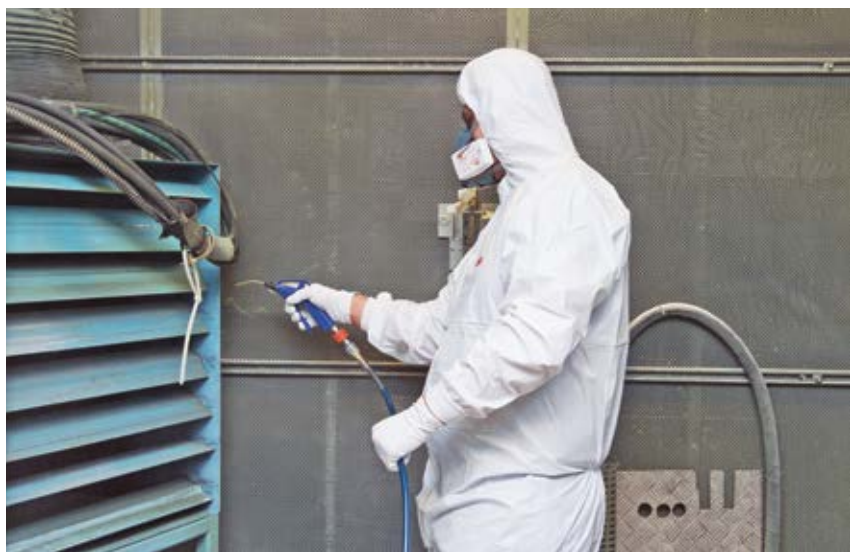
Figura 6 L'aria compressa può essere utilizzata per la pulizia soltanto se, per motivi tecnici, non ci sono altre possibilità e se il sistema di aspirazione della cabina è in funzione.
