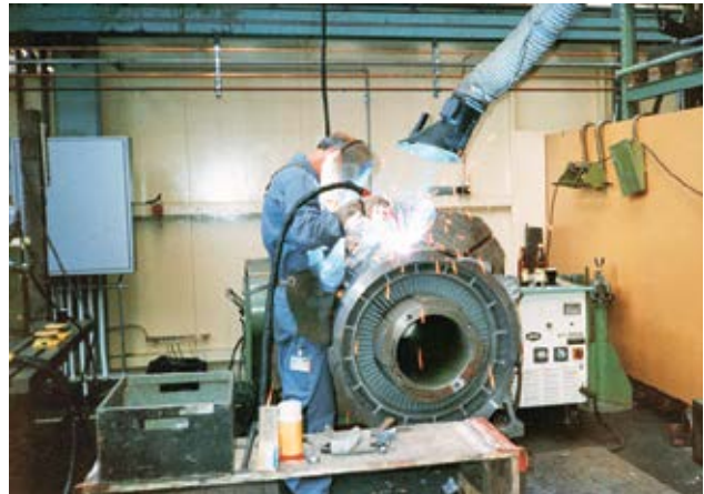
Figura 1 Durante la saldatura MIG/MAG su acciaio legato si formano fumi e polveri contenenti nichel.
