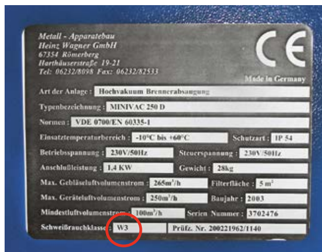
Figura 2 Targhetta del tipo di una torcia aspirante con filtro per fumi di saldatura classe W3.
