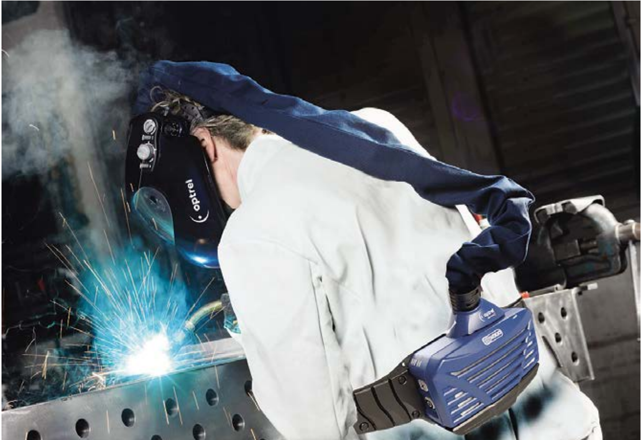
Figura 3 Protezione delle vie respiratorie durante la saldatura MIG/MAG: dispositivo filtrante a ventilazione assistita con casco di saldatura e filtro antiparticolato multiuso di classe TH3P R SL.
