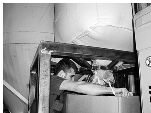
Fig. 5: una stazione di svuotamento dotata di supporto meccanico consente l'apertura sicura del big bag.
