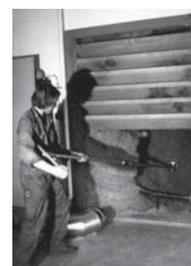
Figg. 5 e 6: attrezzi appropriati per la disgregazione di masse compatte:
