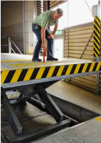
01 // Der Unfall ereignete sich an einer ähnlichen Hebebühne wie dieser (Bild nicht identisch mit Unfallort). Diese Hebebühne kann mit Sicherheitsbolzen gegen unerwartetes Absenken gesichert werden. // Bilder: Suva
