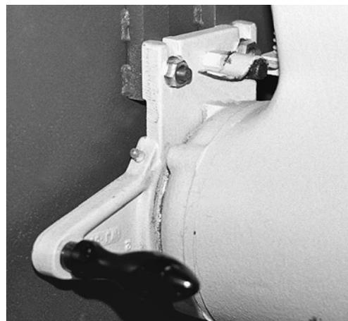
1 Impugnatura isolata e dispositivo di ritenuta della lama circolare in posizione iniziale (molla piatta e perno).
