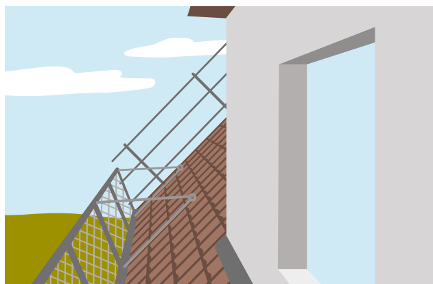
5 Parete di ritenuta sul tetto inadeguata per lavorare su lucernari e abbaini.
