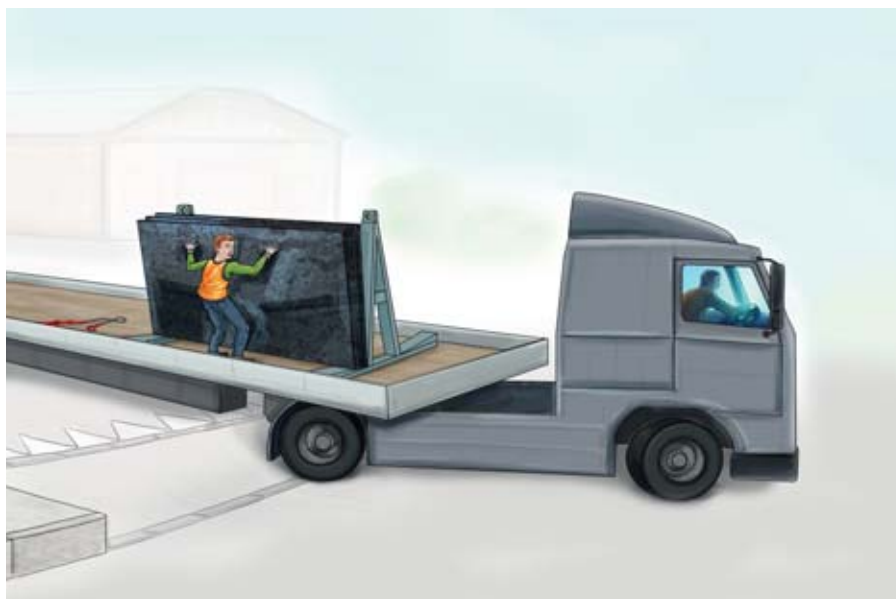
Non sécurisé, le chargement bascule du pont du semi-remorque lors d'une manœuvre.
