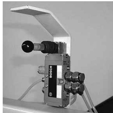
Figure 1: Commande à action maintenue
