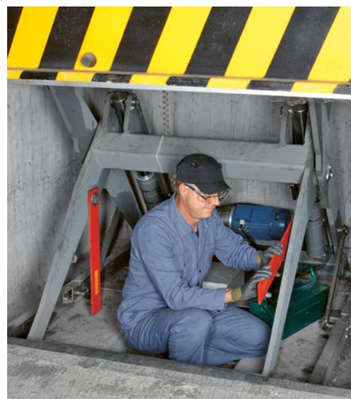
4 In posizione sollevata la piattaforma viene messa in sicurezza con gli stabilizzatori.
