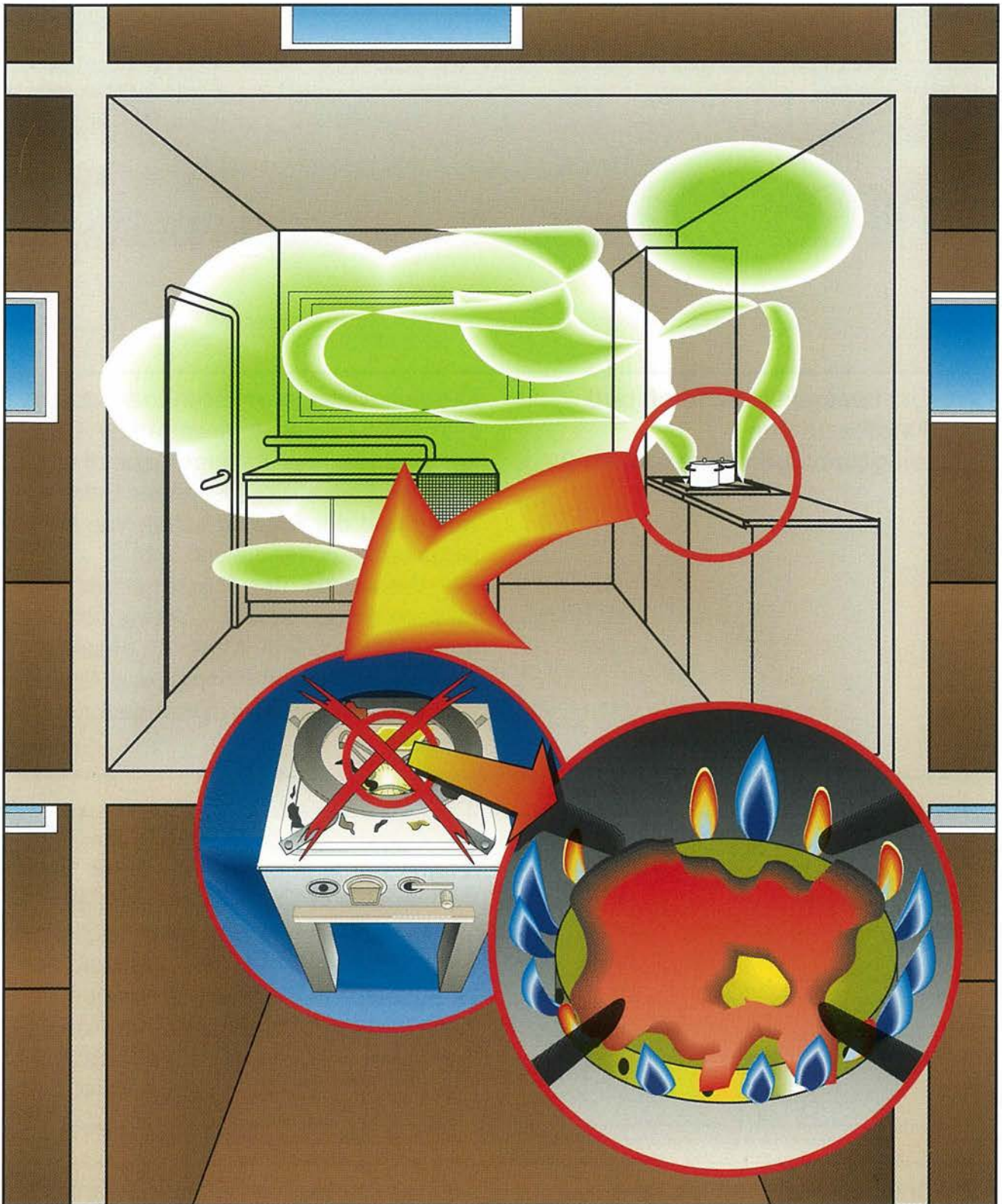
Bild 17: Entstehen von Kohlenmonoxid infolge verschmutzter Brenner
