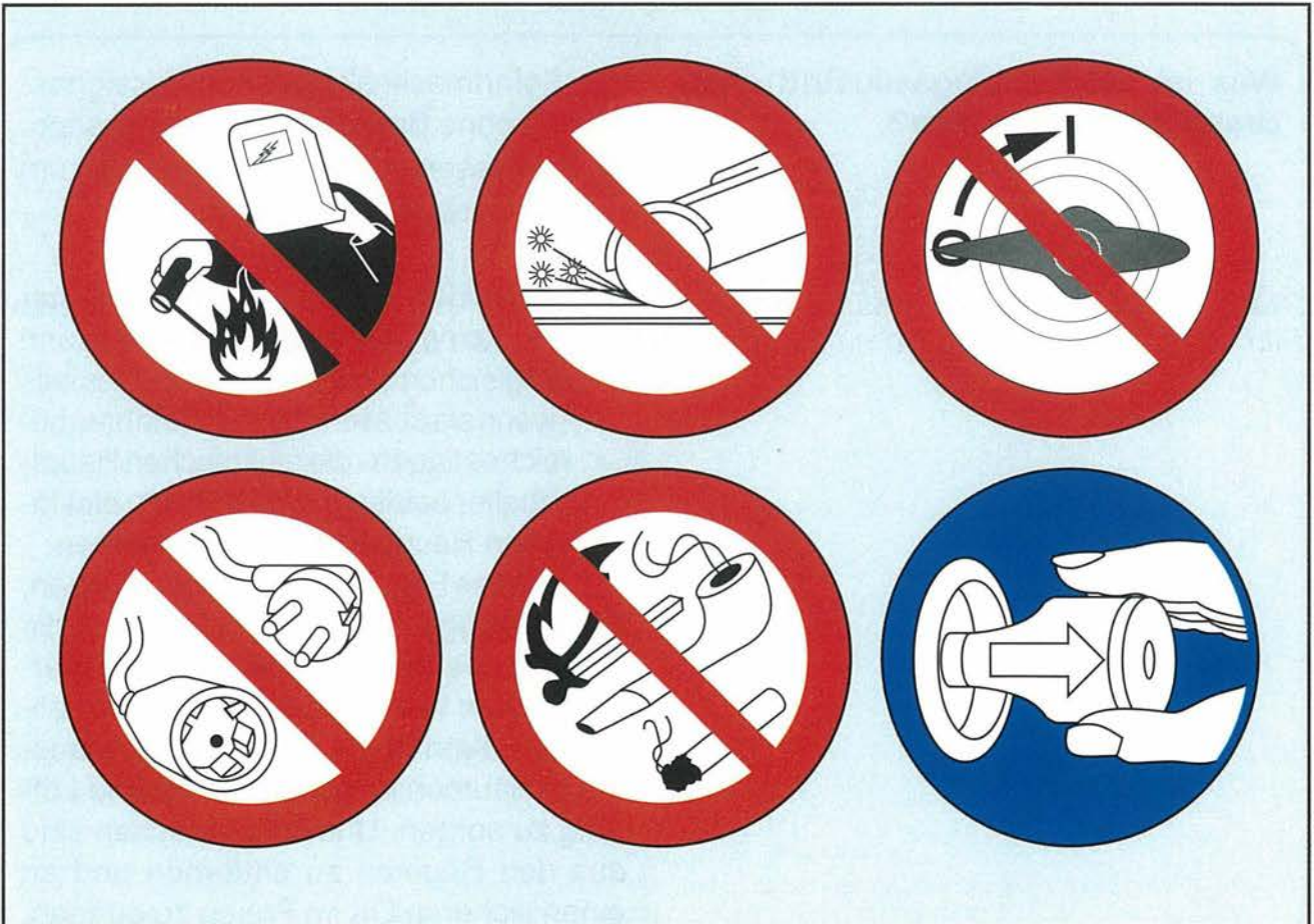
Bild 45: Vermeiden von Zündquellen bei Gasaustritt
