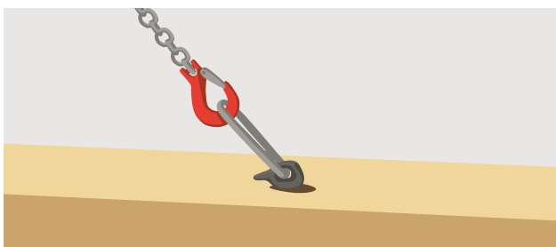
2 Vite per ancoraggi di trasporto per la movimentazione di elementi in legno
