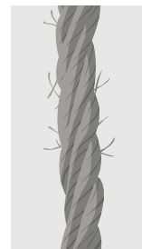
18 Fili metallici rotti
