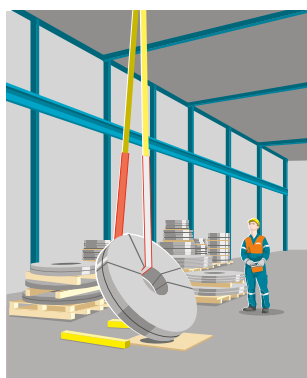
Regola 7 Proteggere gli accessori di imbracatura dal danneggiamento
