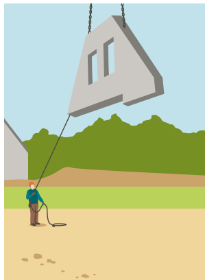
2 Guidare il carico con apposite funi di guida.
