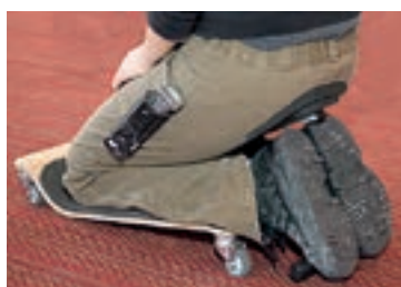
Cuscini e dispositivi salvaginocchia Per lavori da eseguire accovacciati durante i quali ci si alza spesso
