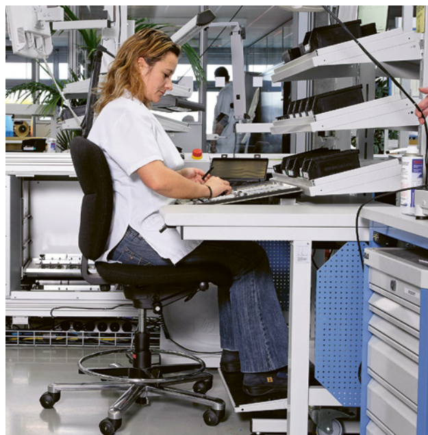
Figura 10 e 11: in questo reparto dove si montano pezzi di precisione la postazione di lavoro deve essere concepita in modo tale da permettere alternativamente la posizione seduta e in piedi.
