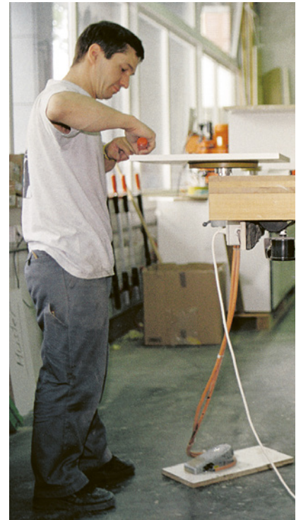
Figure 14, 15 e 16: a seconda della mansione è possibile regolare in altezza la superficie di lavoro del banco da falegname.
