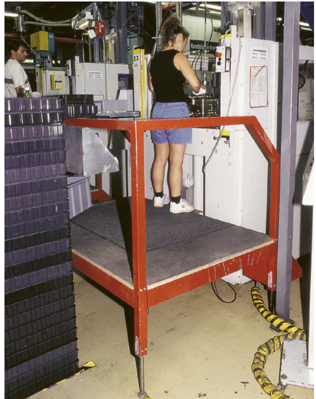
Figura 2: le pedane regolabili in altezza migliorano l'ergonomia e incrementano la produttività del 10 %.
