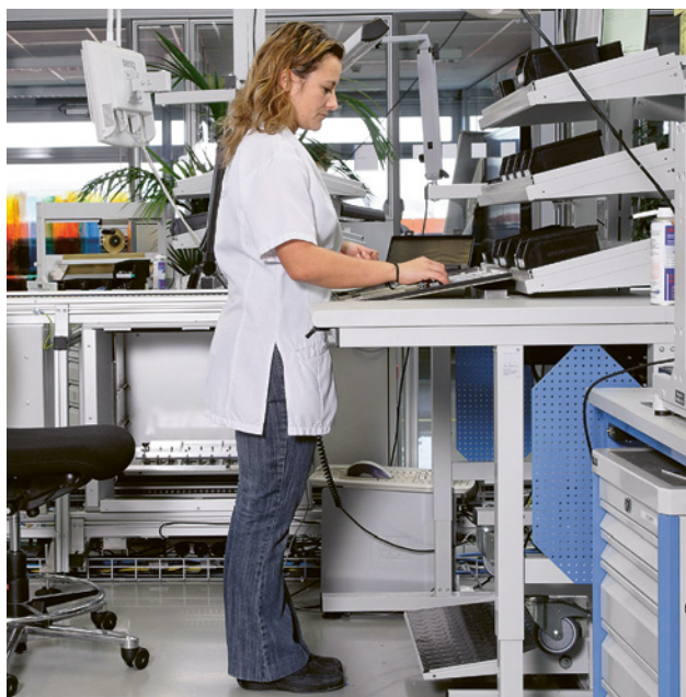
Figura 10 e 11: in questo reparto dove si montano pezzi di precisione la postazione di lavoro deve essere concepita in modo tale da permettere alternativamente la posizione seduta e in piedi.
