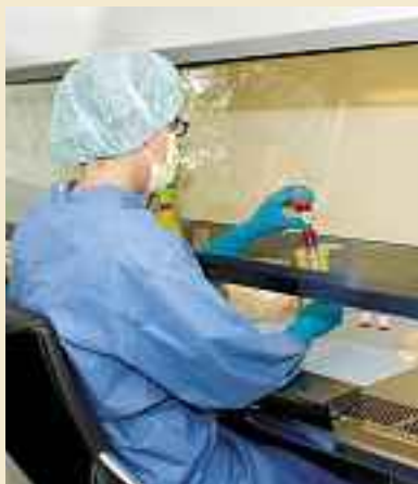
Preparazione di citostatici in una cappa di protezione della classe II
