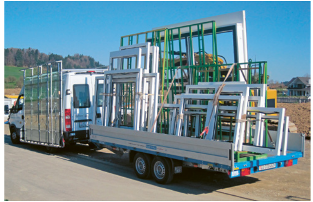
4 Le véhicule de transport doit être adapté au transport prévu et aux équipements et engins de levage utilisés.
