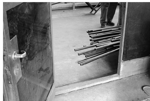
7 Achtung, Stolperfälle. Auch an die Kolleginnen und Kollegen denken!
