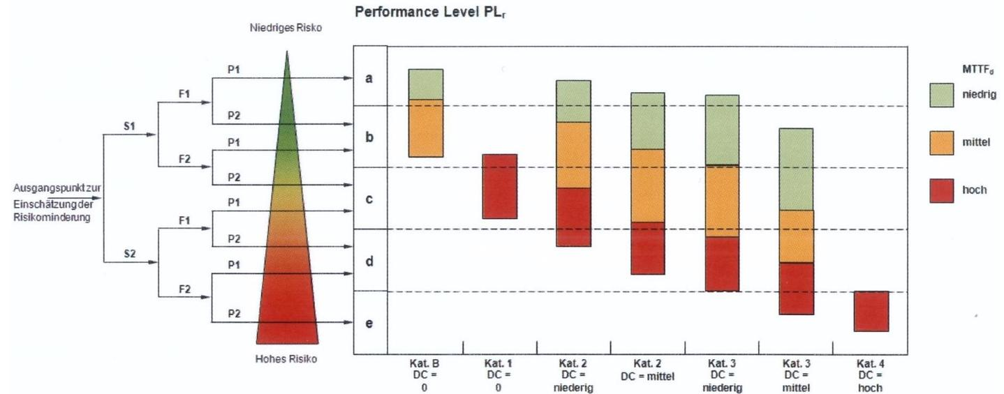
Quelle: Bild A.1 und Bild 5 aus EN ISO 13849-1
