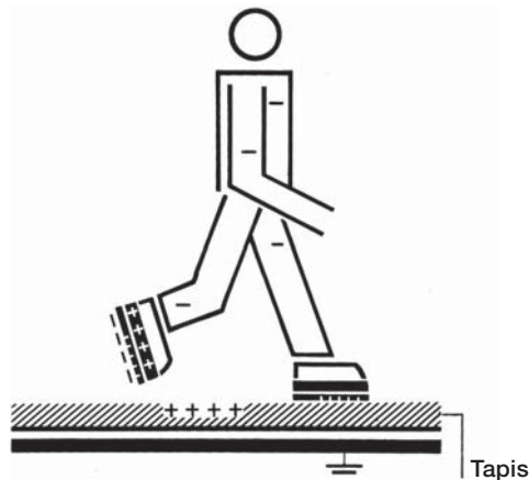
Fig. 27: Contact/séparation (processus de contact/séparation) lorsque l'on se déplace sur un sol [8].
