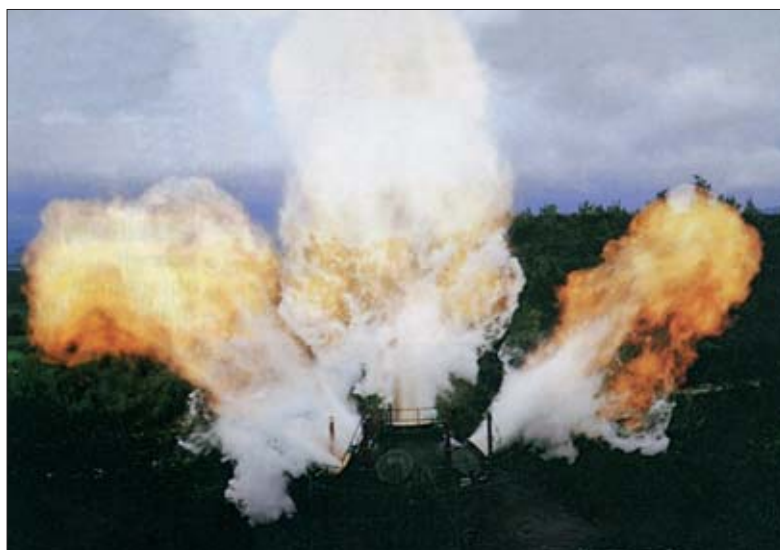
Fig. 8: Explosion secondaire à l'extérieur du récipient [5].
