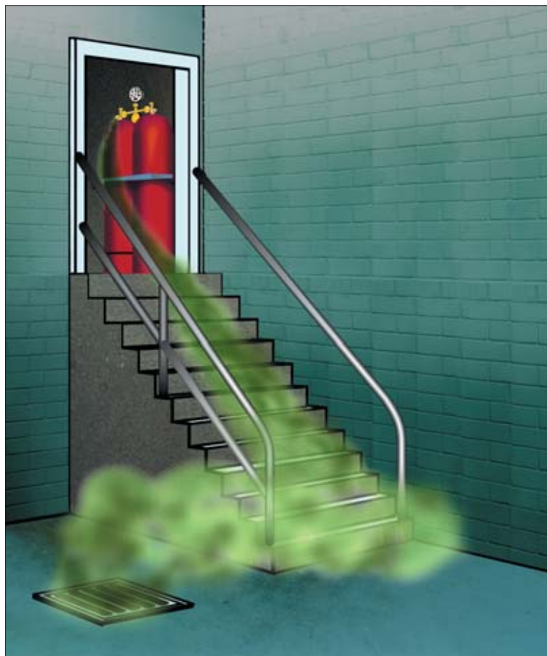
Fig. 28: Mode d'écoulement des gaz liquéfiés [1].
