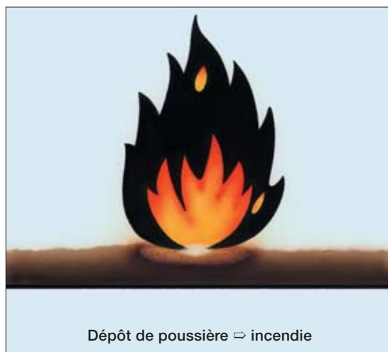
Fig. 21: Différence entre un incendie et une explosion de poussières combustibles [3].
