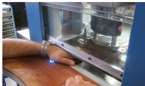
5 Écran mobile équipé d'une barre de contact protégeant les mains ou les doigts des risques d'écrasement.
