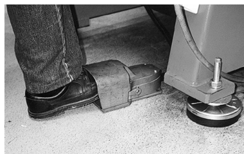
2 La commande à pied (pédale) doit être équipée d'une cape de protection.
