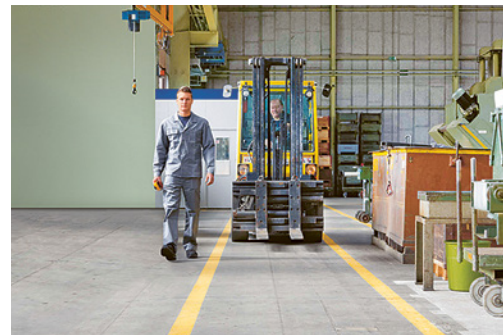
3 Signalisierung des Verkehrswegs und Abgrenzung der Lagerzone
