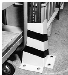
7 Anfahrtschutz an der Ecke eines Regals
