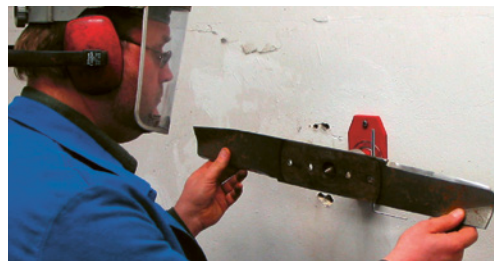
4 Mit diesem Gerät wird geprüft, ob das Messer nach dem Schleifen keine Unwucht hat.
