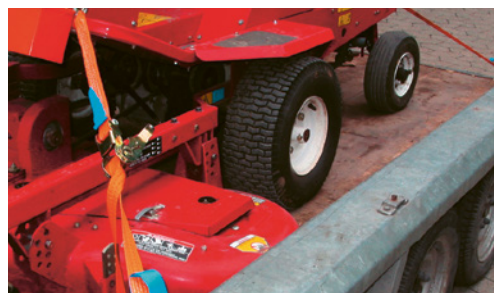
5 Fest verzurte Maschine auf einem Transportanhänger
