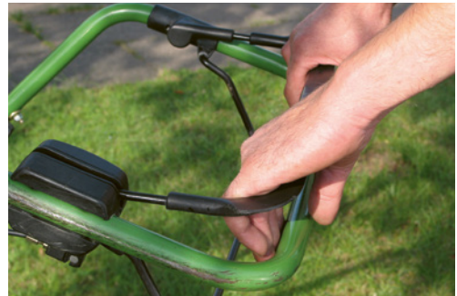
2 Schalteinrichtungen wie diese Tippschaltung müssen einwandfrei funktionieren.
