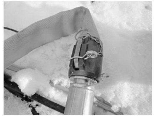
Bild 1: Die Kamlok-Kupplung ist mit einem Federstecker gegen unbeabsichtigtes Öffnen geschützt.
