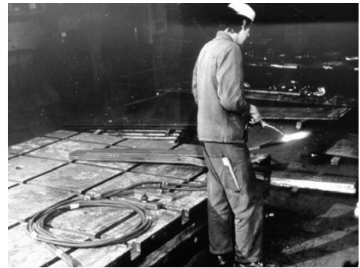
2 Sauber gerollte Schläuche neben dem Arbeitsbereich. So ist die Stolpergefahr gebannt.
