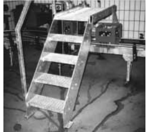
Figura 7: passerella sopra un impianto di trasporto a rulli.
