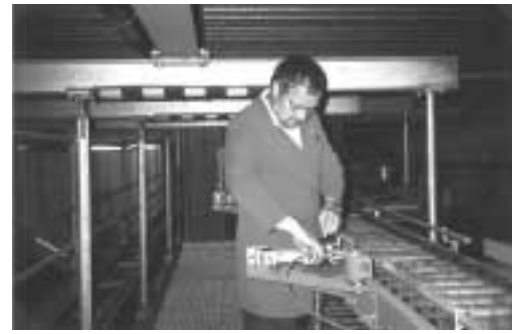
Figura 6: traverse in metallo rivestite di un'imbottitura a strisce gialle e nere.
