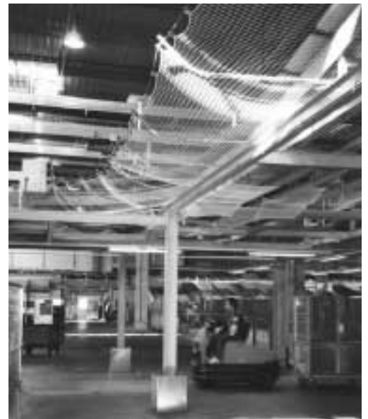
Figura 8: reti di protezione sopra una via di circolazione.
