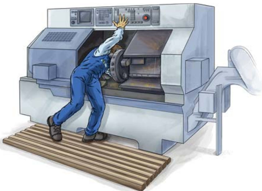
La vittima è rimasta bloccata tra la torretta girevole (revolver) e il mandrino della macchina.
