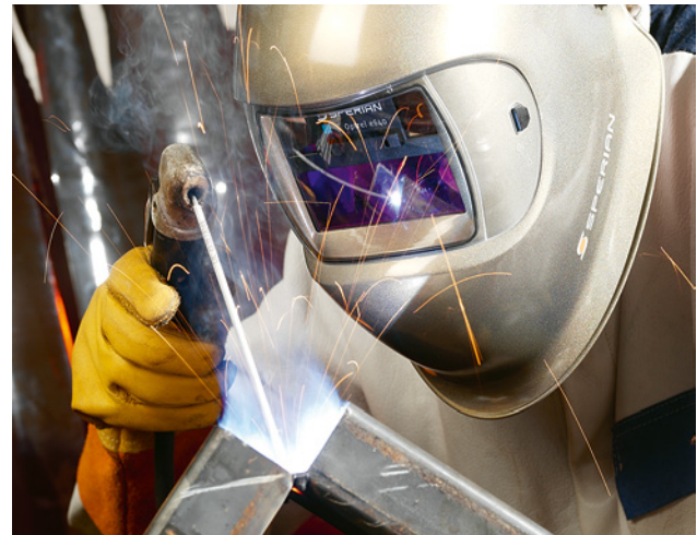
Bild 8 Lichtbogenhandschweissen mit umhüllten Stabelektroden
