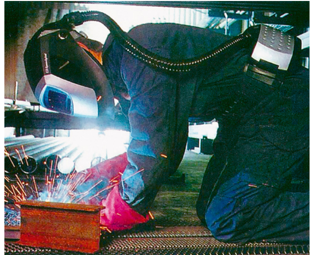
Bild 41 Gebläsefiltergerät mit Schweißhelm und kombiniertem Gas- und Partikelfilter nach SN EN 12941 (Schutzstufe TH2 A1E1B1P)
