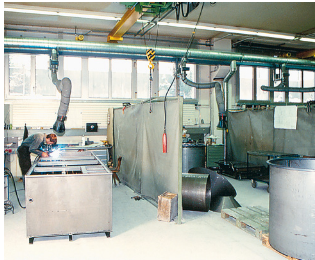
Bild 36 Flexibler Absaugarm mit grosser Reichweite
