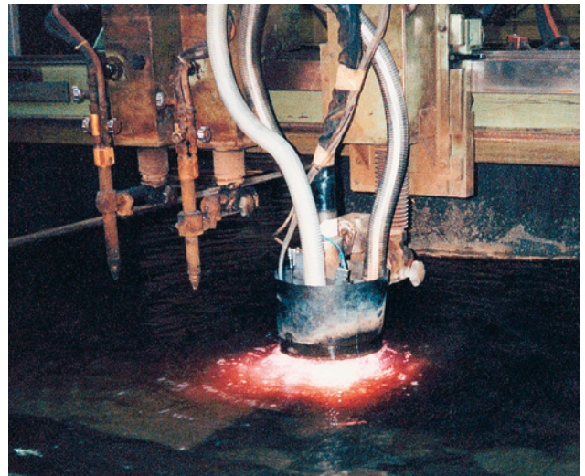
Bild 31 Unterwasserplasmaschneiden von Chrom-Nickel-Stählen
