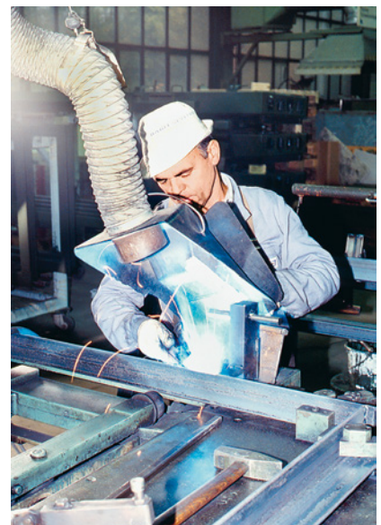
Bild 35 Absaugung am Schutzschild
