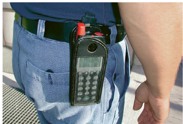
34 Telefonhörer mit integrierter Personen-Notsignal-Anlage. Eine geeignete Alarmorganisation muss aufgebaut sein.
