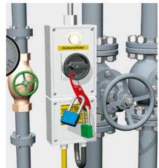
3 Revisionsschalter mit indirekter Abschaltung.
