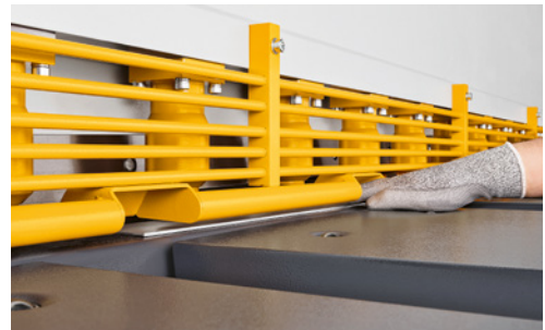
3 Schutzeinrichtung mit Griffmulde und guter Sicht auf die Schnittlinie, was auch das Zuschneiden kleiner Blechteile erlaubt.
