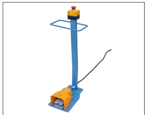
2 Der Fusschalter muss mit einer Schutzhaube ausgestattet sein.
