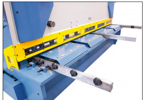
4 Zur Verhütung von Finger- und Handverletzungen muss die Schnittlinie auf der ganzen Länge des Messerbalkens mit einer stabilen Schutzeinrichtung geschützt sein.
